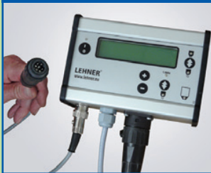
Vorgewende-Manager 2m „7-pol. Signalsteckdose“
