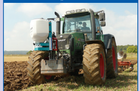
Zwischenfrucht streuen beim Pflügen mit Abweisblech „verstellbar“
