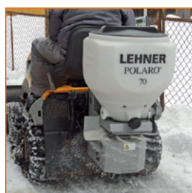
POLARO® 70 am ATV mit Schneeräumschild
