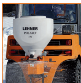
POLARO® 170 am Gabelstapler mit Schneeräum- schild
