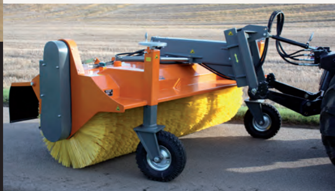
bema Jumbo am Schlepper mit Front Dreipunktanbau.
