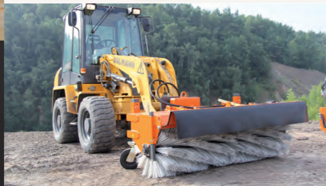
Der Spritzschutz an der bema 3 Robust verhindert frei umherfliegenden Schmutz.
