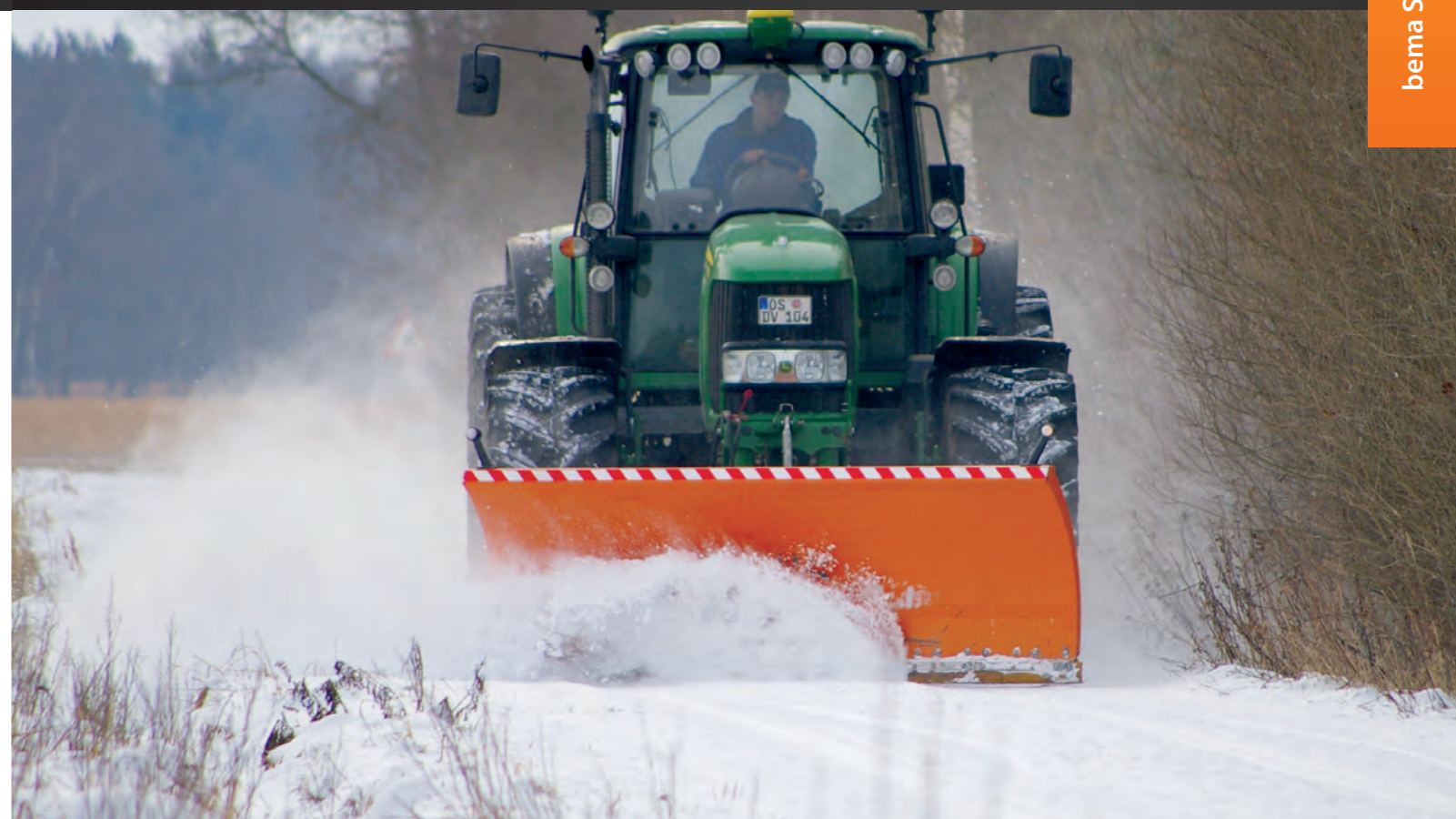
Variante 1: Schneeschild mit Federklappen und Laufrädern.
