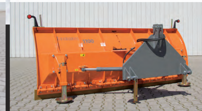
Variante 2: Schneeschild mit Federklappen und Gleitkufen.
