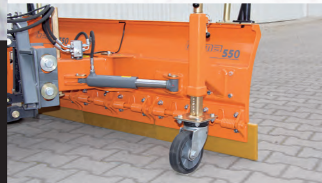
Variante 1: Schneeschild mit Federklappen und Laufrädern.
