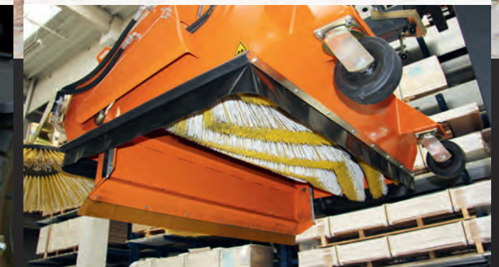
Kehrwalzenbesatz mit links- und rechts-Drall zur optimalen Reinigung aller Böden.
