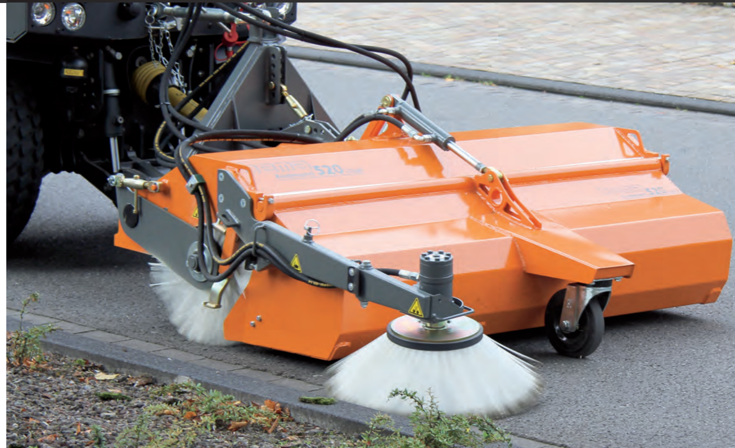
bema Kommunal 600 Dual mit mechanischem Antrieb und Seitenkehrbesen.
