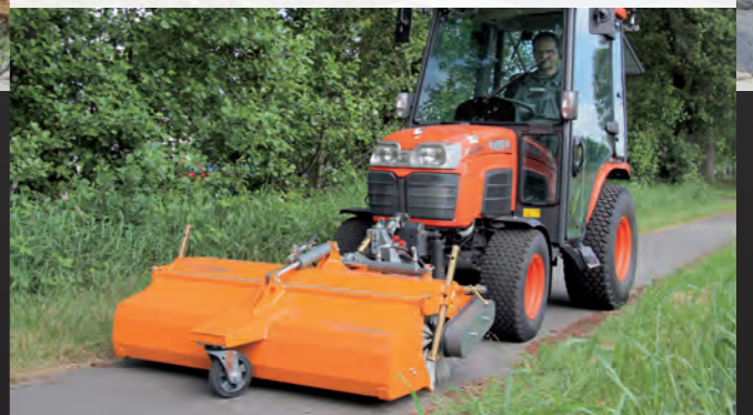
Anbau an Kompaktschlepper: bema Kommunal 400 Dual mit Schmutzsammelwanne.
