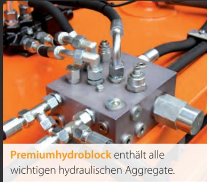
**Premiumhydroblock** enthält alle wichtigen hydraulischen Aggregate.
