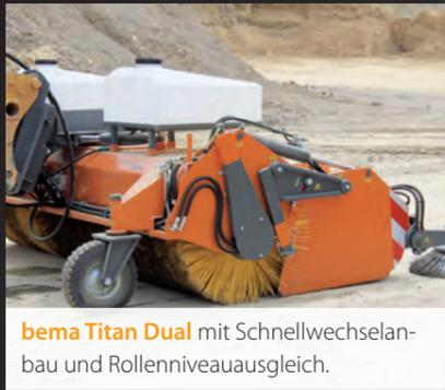
**bema Titan Dual** mit Schnellwechsellbau und Rollenniveaueausgleich.
