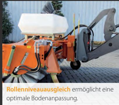
**Rollenniveaueausgleich** ermöglicht eine optimale Bodenanneppung.
